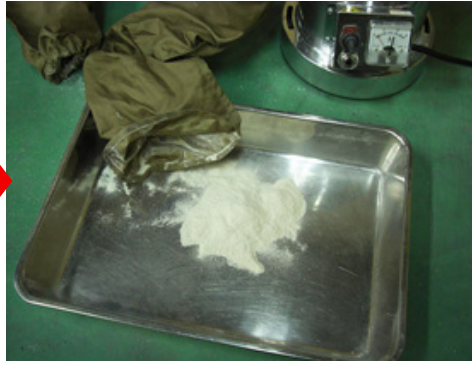
電流計にて投入ペース調整(黒線内で使用) 下部回収袋より粉碎物を取り出す
